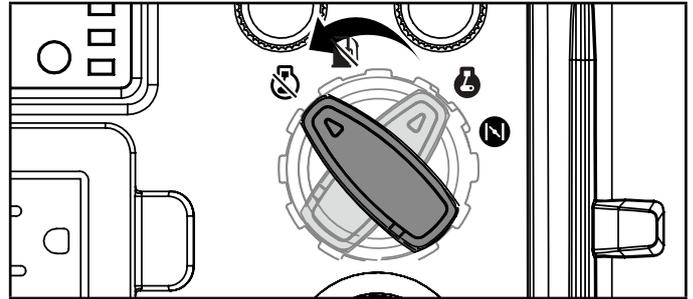
**Importante:** Siempre asegúrese de que el dial EZ Start y la palanca de ventilación de combustible en la tapa de combustible estén en posición "APAGADO" cuando el generador no esté en funcionamiento.
