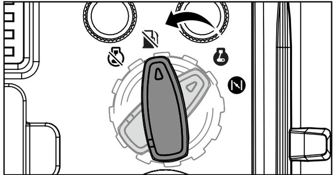
4. Permita que el generador corra hasta que el motor se detenga completamente de la falta de combustible.
