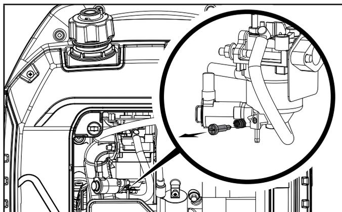
6. Cuando la gasolina pare de fluir del tubo transparente, gire el tornillo de drenaje a reloj (derecha) hasta que se apriete. Deshágase de la gasolina drenada en acuerdo con las regulaciones y normas locales.
