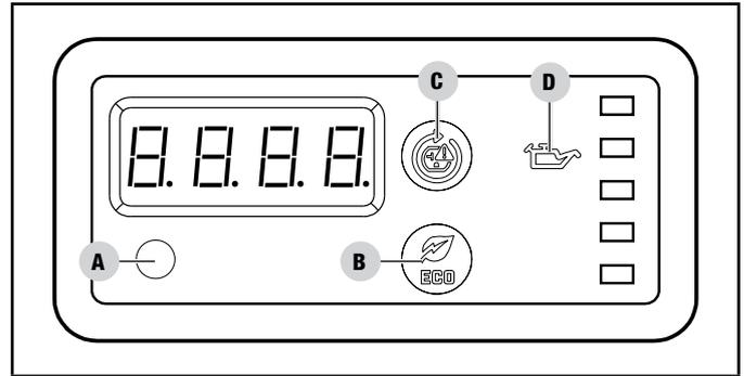
C. **Botón de restablecimiento de sobrecarga CA** – Utilizado para dar energía de nuevo a los receptáculos después de falla de sobrecarga.
