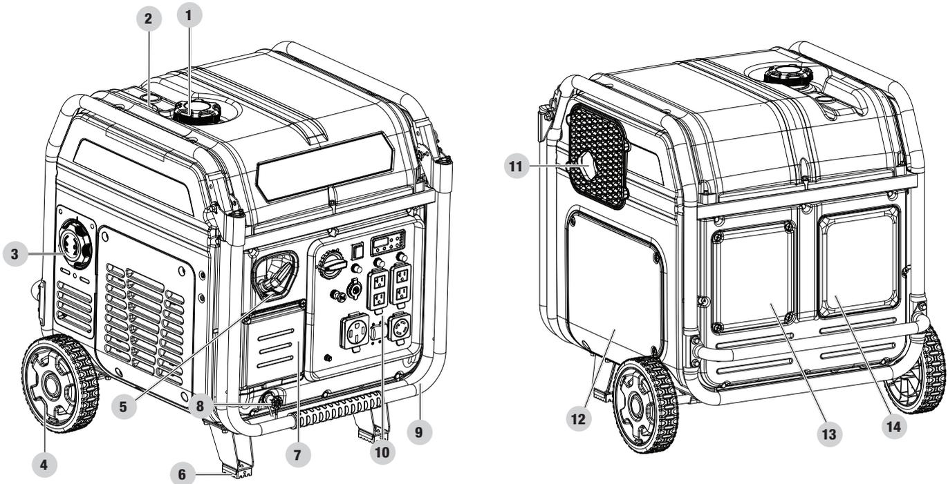
1. **Bouchon du réservoir de carburant** – Retirer pour ajouter du carburant.
