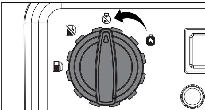
**Important:** Assurez-vous toujours que le cadran sélecteur de carburant sont en position « MOTEUR ARRÊT » lorsque la génératrice n'est pas utilisée.
