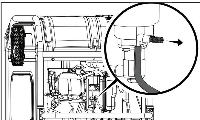
5. Lorsque le carburant ne circule plus dans la tubulure transparente, serrez fermement la vis de vidange en la tournant dans le sens des aiguilles d'une montre. Jetez l'essence vidangée conformément aux règlements et directives locales.
