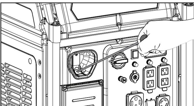
9. Si le moteur ne démarre pas après 1 traction et un étrangleur positionné sur « EN MARCHÉ », déplacez l'étrangleur à la position « ÉTRANGLEUR » et répétez l'étape d'Amorçage Par Traction.
