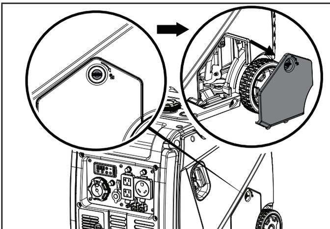
3. Retire la tapa de llenado de medición de aceite para agregar el aceite.
