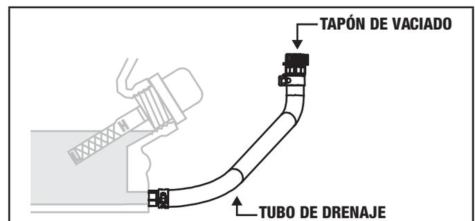
4. Asegúrese de que la manguera de drenaje de aceite esté más bajo que el motor inferior al motor y permita que el aceite drene completamente en un recipiente adecuado.
