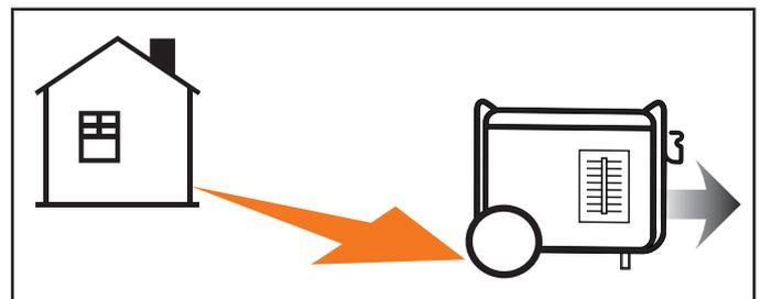
Si se usa indebidamente y se opera en un lugar no aprobado e inseguro que resulta en la acumulación de gas CO venenoso dentro de un espacio cerrado o parcialmente cerrado, por ejemplo, una casa, garaje o garaje con la puerta parcialmente abierta, CO Shield® apagará automáticamente el generador y luego iluminará una luz LED roja parpadeante. **Lea la etiqueta de acción para conocer los siguientes pasos.**
