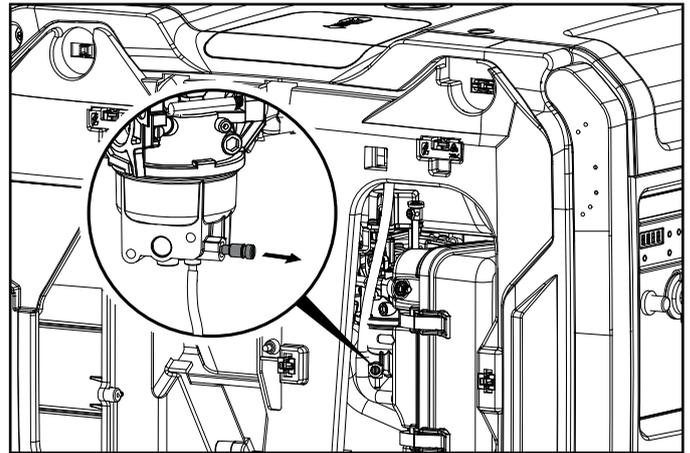
6. Lorsque le carburant ne circule plus dans la tubulure transparente, serrez fermement la vis de vidange en la tournant dans le sens des aiguilles d'une montre. Jetez l'essence vidangée conformément aux règlements et directives locales.
