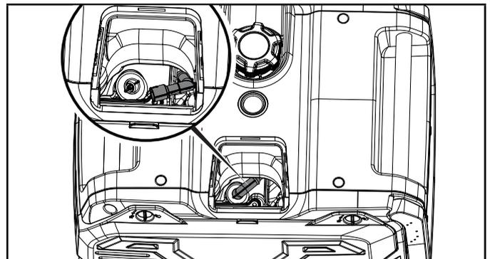
3. Utilisez un outil de démontage de bougie (inclus), ou une douille de 21 mm (13/16 po) (non incluse) pour retirer la bougie.
