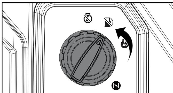
4. Laissez fonctionner la génératrice jusqu'à ce que le moteur s'arrête par manque d'essence.
