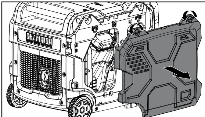
2. Localisez le couvercle en plastique du filtre à air et retirez en déverrouillant les loquets de verrouillage et en retirant le couvercle.
