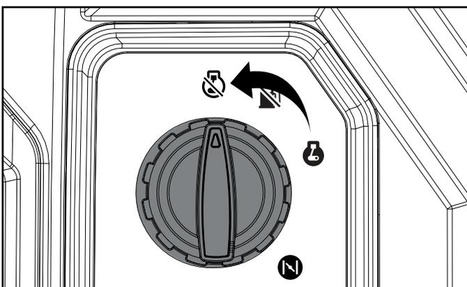
**Important :** Assurez-vous toujours que le cadran EZ Start est en position « ARRÊT » lorsque la génératrice n'est pas utilisée.
