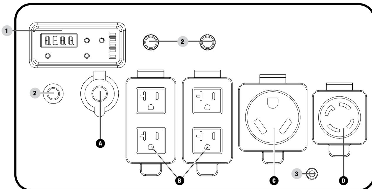
1. **Jauge intelligente avec wattmètre** – Voir la section « Jauge intelligente avec wattmètre ».
