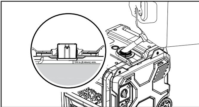
3. Le niveau de carburant approximatif est indiqué sur la jauge à carburant située en haut du réservoir.
