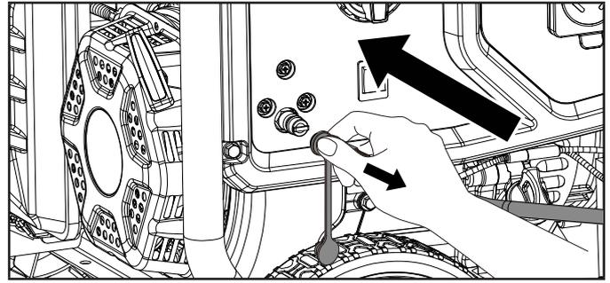
4. Conecte el otro extremo de la manguera al conector de GLP en el cilindro y apriete con la mano.
