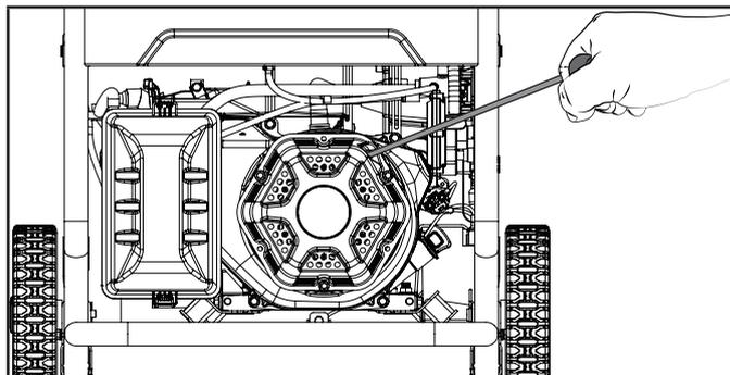
6. Tan pronto como arranque el motor, mueva lentamente el ahogador a la posición "CORRER" por una duración de 2-5 segundos.
