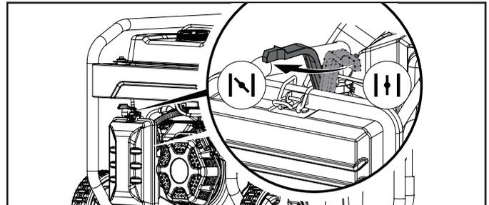
6. Abra completamente la válvula en el cilindro GLP.
