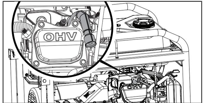
3. Revise el electrodo en la bujía. Debe estar limpio y no desgastado para producir la chispa de encendido.
