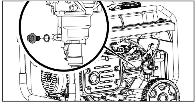
5c. Cuando la gasolina pare de fluir del carburador, reemplace y apriete el perno de drenaje del carburador y asegúrese de deshacerse de la gasolina drenada en acuerdo con las regulaciones y normas locales.
