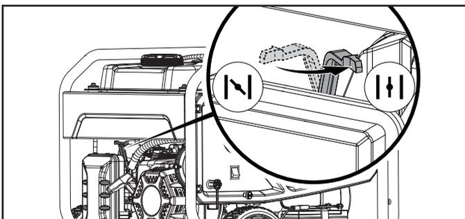
9. Jale la cuerda de arranque lentamente hasta sentir resistencia, luego jale rápidamente.
