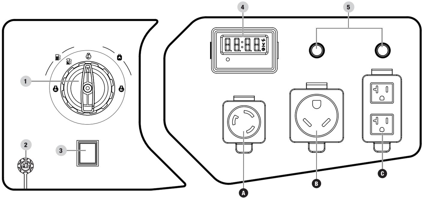
1. **Dial selector de combustible** – Utilizado para seleccionar y activar la fuente de combustible de gasolina o propano (GLP).
