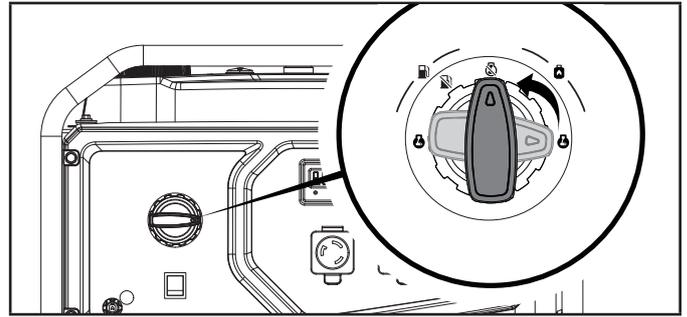
4. Si opera con GLP, cierre la válvula en el cilindro de GLP.
