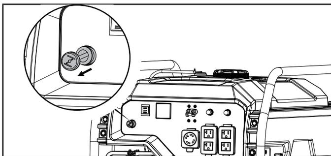
5. Appuyez et maintenez le commutateur d'allumage à la position « START » (démarrage). Relâchez-le dès que le moteur commence à tourner. Si le moteur ne démarre pas dans les cinq secondes, relâchez le commutateur et attendez au moins dix secondes avant de tenter un nouveau démarrage du moteur.
