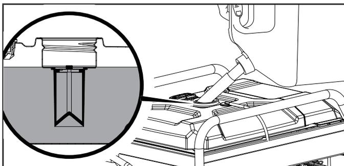
3. Le niveau de carburant approximatif est indiqué sur la jauge à carburant située en haut du réservoir.
