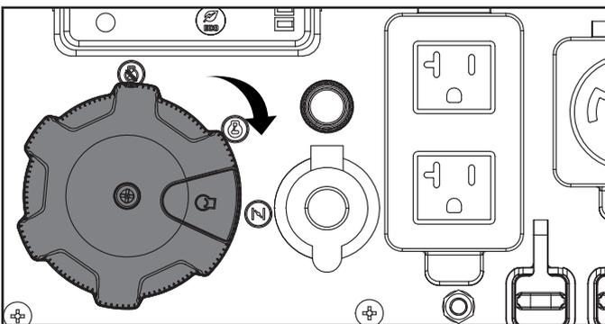
5. Appuyez et maintenez le commutateur d'allumage jaune sur le cadran de démarrage EZ vers le centre du cadran pendant 2-3 secondes.
