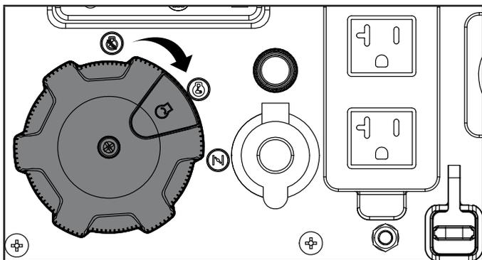
5. Appuyez sur le contacteur d'allumage jaune sur le sélecteur tournant EZ Start vers le centre du cadran et maintenez-le enfoncé. Relâchez-le dès que le moteur démarre. Si le moteur ne démarre pas en cinq secondes, relâchez le commutateur et attendez au moins dix secondes avant d'essayer à nouveau de démarrer le moteur, et le sélecteur EZ Start à la position « MARCHE », et maintenez le contacteur d'allumage sur le sélecteur EZ Start.
