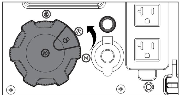
7. Appuyez et maintenez enfoncé le commutateur d'allumage jaune sur le cadran EZ Start vers le centre du cadran pendant 5 secondes maximum ou jusqu'au démarrage.
