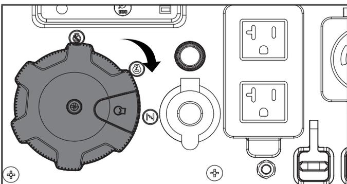
4. Appuyez sur le contacteur d'allumage jaune sur le sélecteur tournant EZ Start vers le centre du cadran et maintenez-le enfoncé. Relâchez-le dès que le moteur démarre. Si le moteur ne démarre pas en cinq secondes, relâchez le commutateur et attendez au moins dix secondes avant d'essayer à nouveau de démarrer le moteur.
