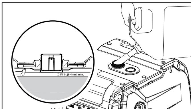
3. Le niveau de carburant approximatif est indiqué sur la jauge à carburant située en haut du réservoir.
