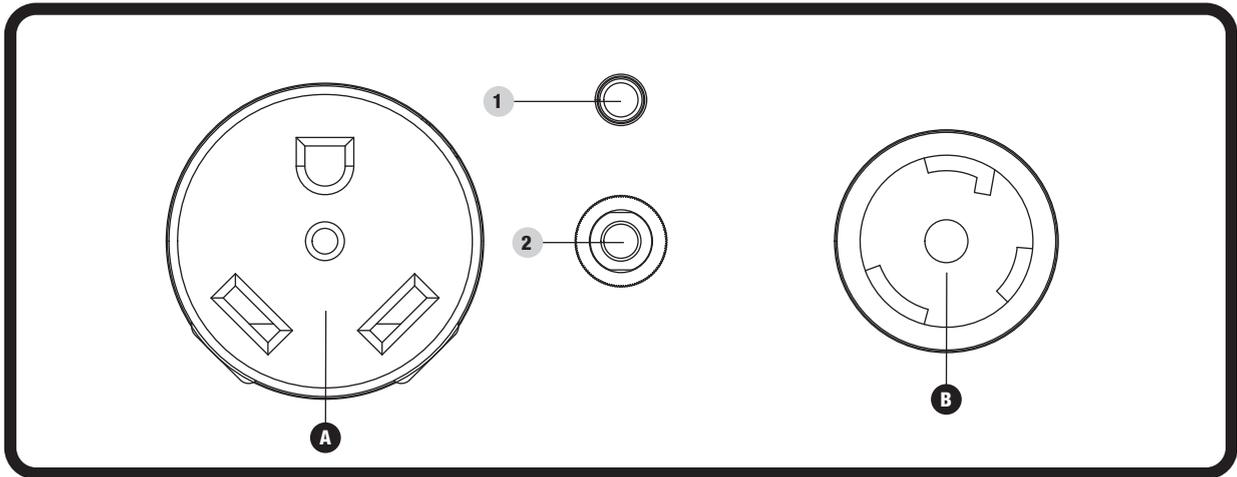
1. **Luz indicadora de salida** – Permanece ENCENDIDA durante condiciones de operación normales. Se APAGA cuando el generador se sobrecarga.
