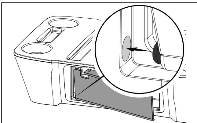
2. Coloque el pasador bisagra del lado derecho en la ranura guía del marco de la puerta. Usando una fuerza estable del lado superior derecho, deslice la puerta hacia abajo hasta que el pasador bisagra entre en su lugar.
