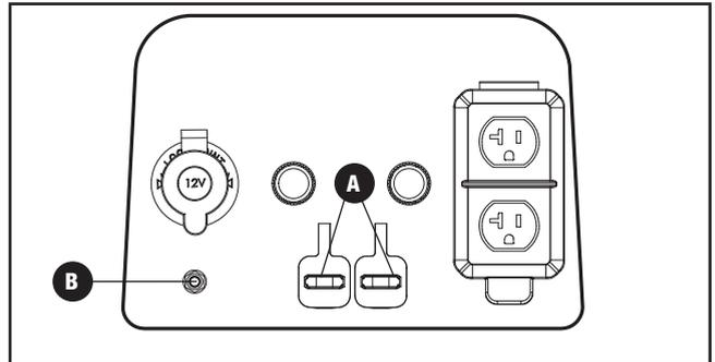
6. Enchufe el segundo par de cables conectando rojo con rojo y negro con negro (A), y cable de tierra (B) al inversor #2.
