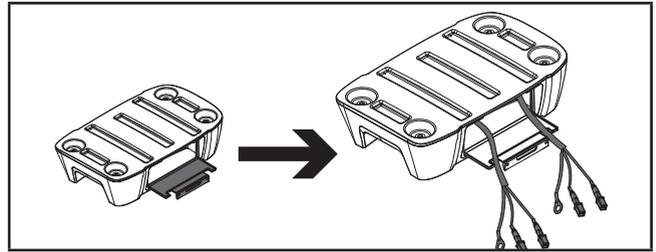
5. Enchufe un par de cables - conectando rojo con rojo y negro con negro (A), y cable de tierra (B) al inversor #1.
