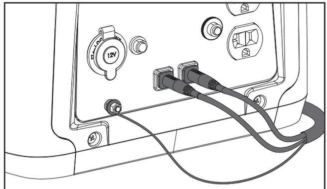
7. Encienda ambos motores de los inversores en acuerdo con el manual del operador. Observe la luz verde indicadora de salida en el panel del equipo en paralelo - cuando la luz encienda, usted puede conectar dispositivos.
