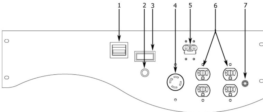
**(1) Interrupteur du moteur** – Basculez l'interrupteur sur « On » (marche) et tirez sur le lanceur à rappel pour lancer la génératrice. Mettez-le sur « Off » (arrêt) pour éteindre la génératrice.
