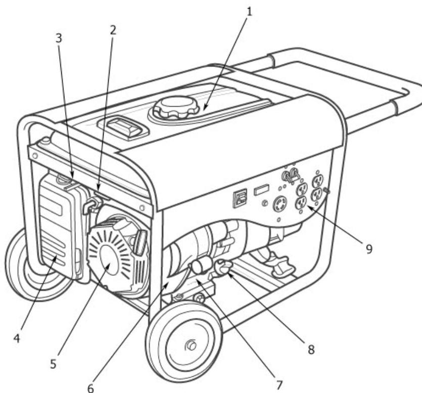
**Réservoir à carburant (1)** – Réservoir à carburant de 24 l (6,34 gallons).
