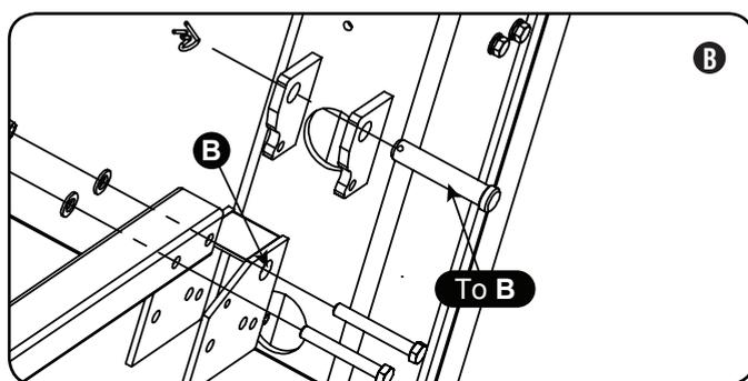
5. Una vez que el soporte en la base de la vigueta quede alineado con la barra de remolque, afíncelo con el pasador y el pasador en R. (C)
