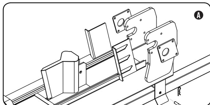
3. Instale el cilindro deslizando las clavijas situadas en el extremo del mismo dentro de las ranuras de montaje en la parte superior de la vigueta. Cerciñese de deslizar el cilindro totalmente hacia adentro en las ranuras de montaje. (B)
