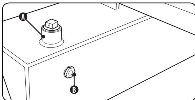
6. Arranque el motor. Extienda y retraiga la cuña para purgar el aire del sistema hidráulico. Cuando el movimiento de la cuña sea suave, el sistema estará debidamente purgado.
