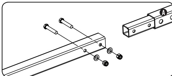
2. Una la barra de remolque al soporte encima del tanque de aceite hidráulico con los dos tornillos M12 x 85 y las contratuercas M12. (B) Ajuste hasta 50 pies/libras.
