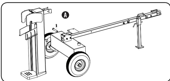
2. Levante lentamente la parte delantera de la barra de remolque para rodar el bastidor hacia la vigueta y alinee cuidadosamente los quicios de la base de la vigueta con los de la parte superior del tanque de aceite hidráulico.
