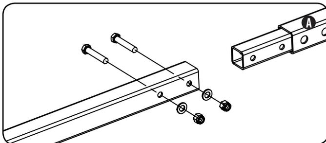
2. Fixer la barre de remorquage sur le support du dessus du réservoir d'huile hydraulique avec deux boulons M12 x 85 et deux contre-écrous M12. (B) Serrer à 50 pieds-livres.
