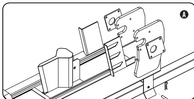
3. Installer le cylindre en glissant les taquets à l'extrémité du cylindre dans les ouvertures de montage sur le dessus de la poutrelle. S'assurer de glisser le cylindre complètement vers l'arrière dans les ouvertures de montage. (B)
