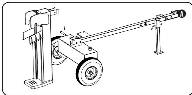
2. Soulever lentement le devant de la barre de remorquage pour faire rouler le cadre vers la poutrelle et bien centrer les trous du pivot sur le bas de la poutrelle avec le dessus du réservoir d'huile hydraulique.
