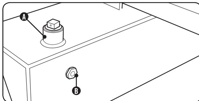
10. Tourner la soupape de carburant en position marche et démarrer le moteur. Purger l'air du système en tirant et poussant le coin à plusieurs reprises jusqu'à ce que le mouvement se fasse facilement.
