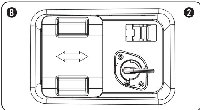
Para activar una válvula de combustible a la posición de la válvula debe estar en posición horizontal. (2)
