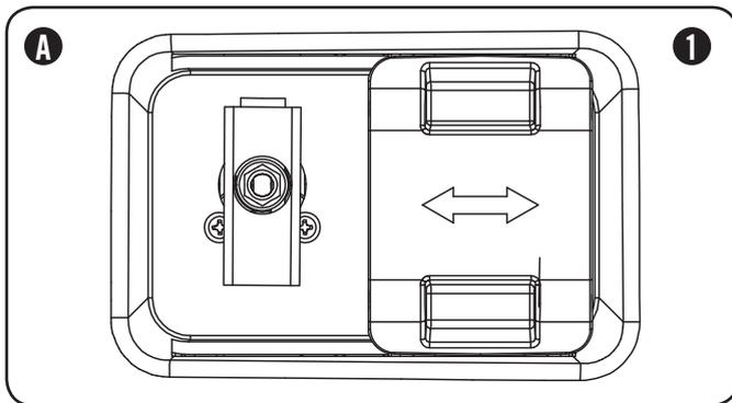
Una vez se ha seleccionado una fuente de combustible, el usuario debe activar la válvula de combustible a la posición vertical para abrir la válvula de combustible. (1)
