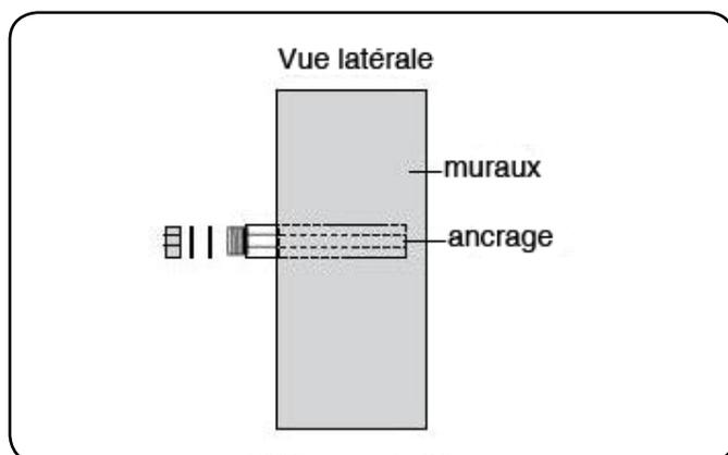
4. Placer le dévidoir sur les ancrages à béton muraux.
