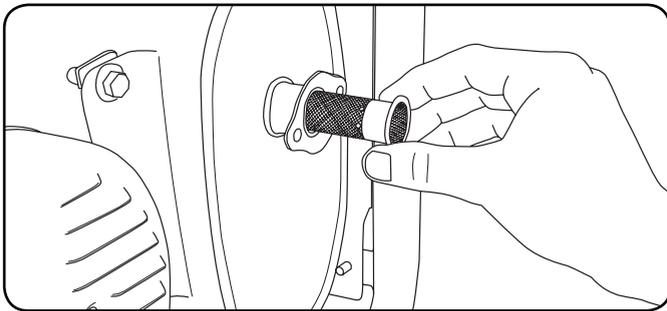
3. Afiance la placa protectora con los dos tornillos y arandelas de seguridad que vienen con el juego de parachispas.
