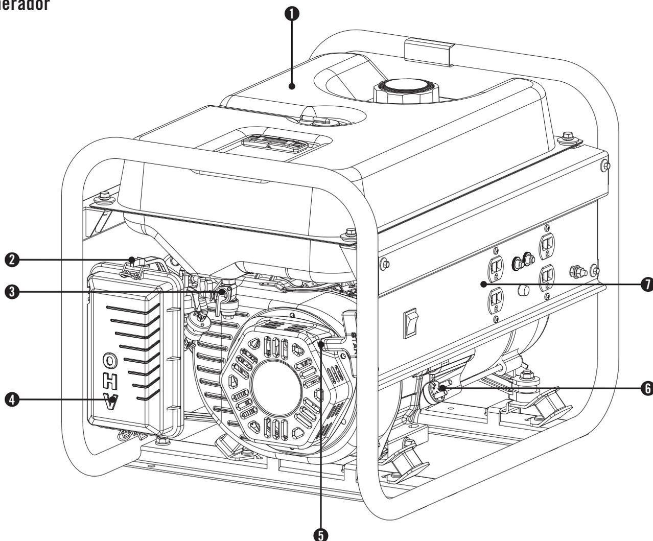
(1) **Tanque de combustible** – Tanque con capacidad de 14,4 litros (3,8 galones).
