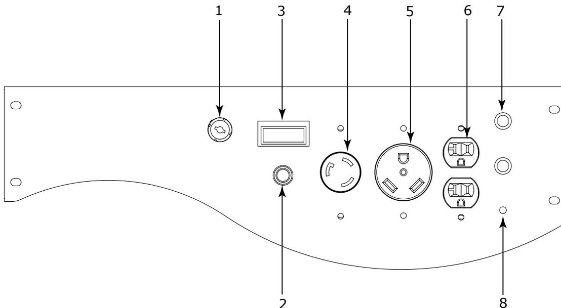
**(1) Interruptor de encendido** – Coloque el interruptor en la posición de encendido “Start” para arrancar el generador. Colóquelo en la posición de apagado “Off” para apagarlo.
