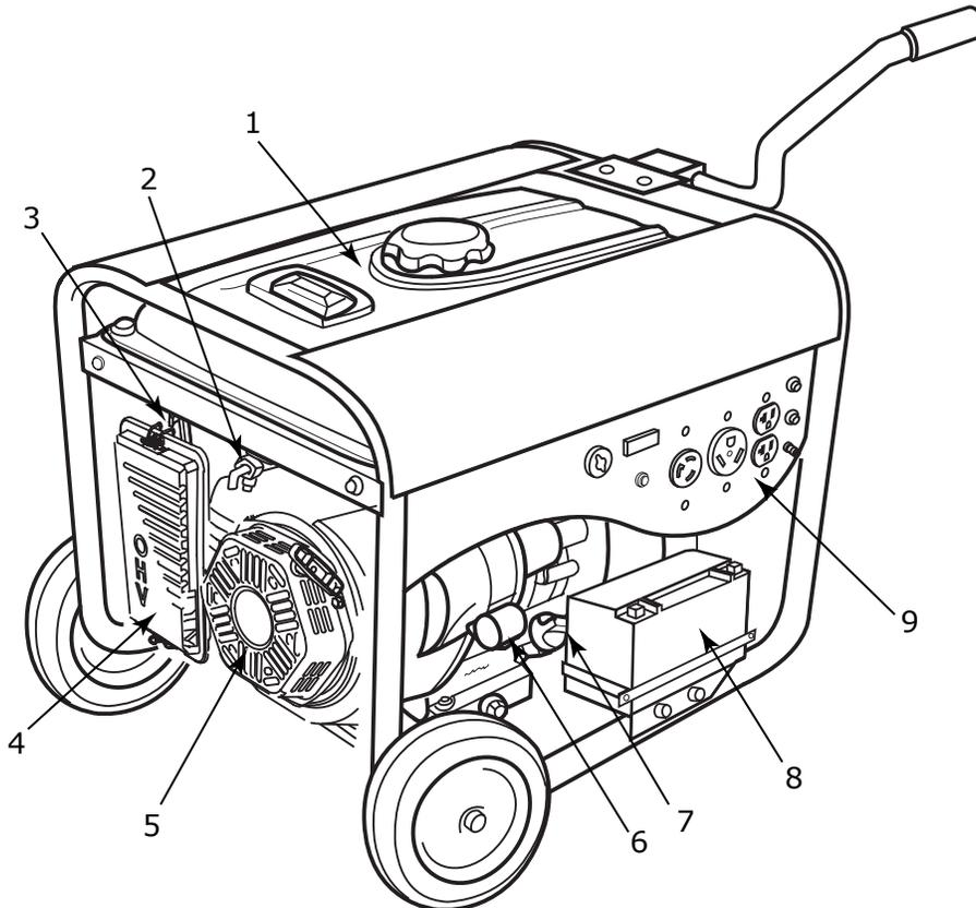
**(1) Tanque de combustible** – Tanque con capacidad de 4,0 galones.
