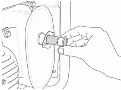
Afiance la placa protectora con los dos tornillos y arandelas de seguridad que vienen con el juego de parachispas.
