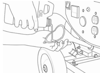
3. Agregue 0,63 cuartos de galón (0,6 L) de aceite y vuelva a colocar la tapa de llenado/varilla indicadora de aceite. Vea “Especificaciones” para la recomendación del aceite basados en las condiciones de funcionamiento.
