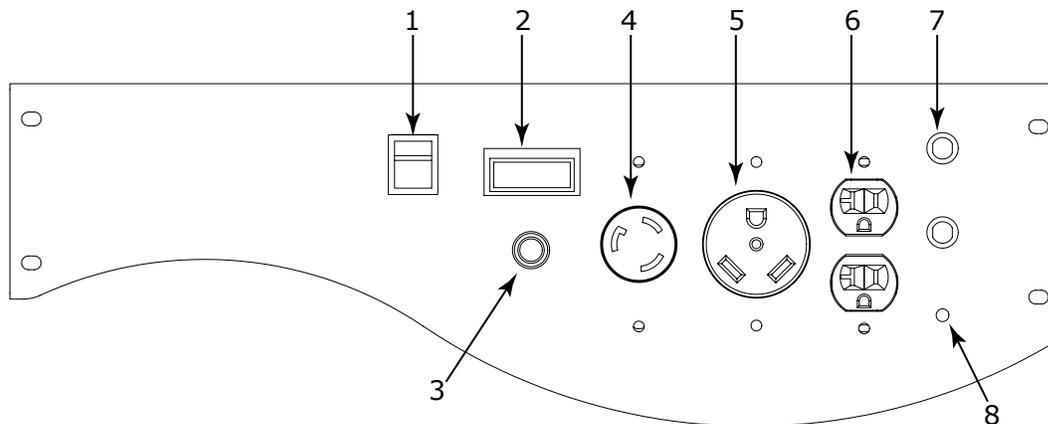
**(1) Interruptor de encendido** – Coloque el interruptor en la posición de encendido “On” para arrancar el generador. Colóquelo en la posición de apagado “Off” para apagarlo.
