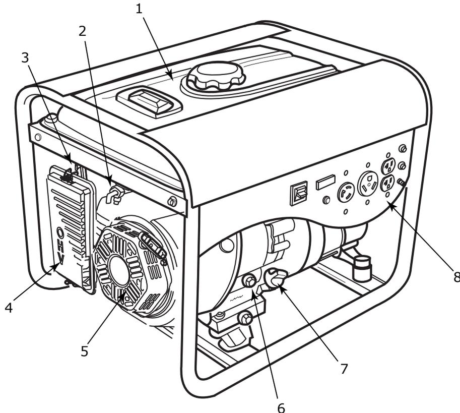
**(1) Tanque de combustible** – Tanque con capacidad de 4,0 galones.
