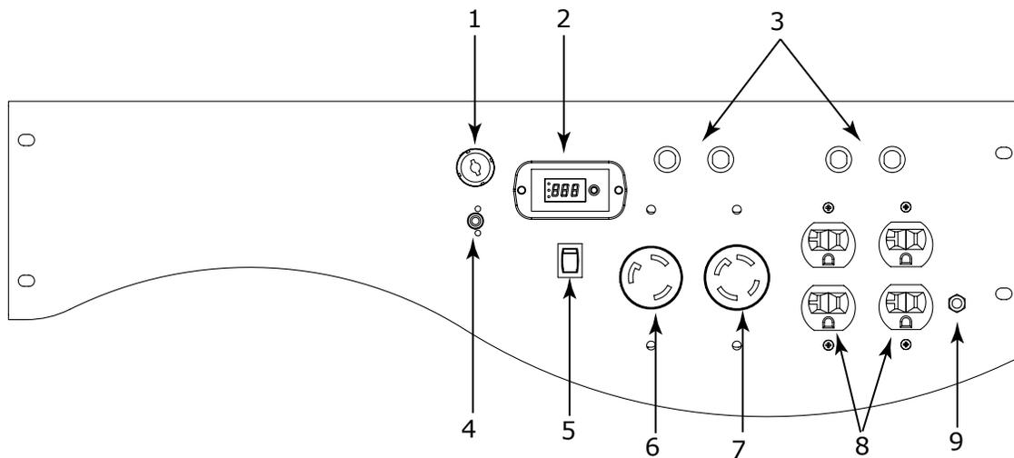
**(1) Interruptor de encendido** – Coloque el interruptor en la posición de encendido “On” para arrancar el generador. Colóquelo en la posición de apagado “Off” para apagarlo.
