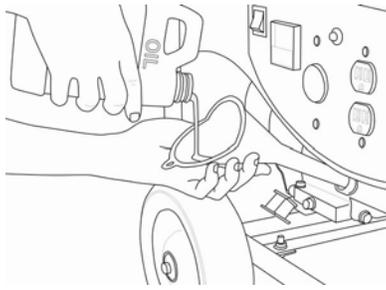
3. Agregue 1,16 cuartos de galón (1,1 L) de aceite y vuelva a colocar la tapa de llenado/varilla indicadora de aceite. Vea “Especificaciones” para la recomendación del aceite basados en las condiciones de funcionamiento.
