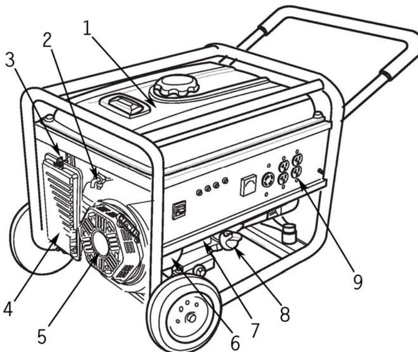
**(1) Tanque de combustible** – Tanque con capacidad de 6,5 galones (25L).
