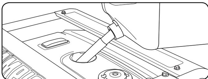
6. Atornille la tapa del tanque y limpie con un paño todo el combustible derramado.
